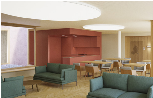
LED-Deckenleuchten im Aufenthaltsbereich verbreiten circadianes Licht, sofern die Wohngruppe dies wünscht.
